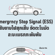
Emergency Stop Signal (ESS) ສັນຍານໄຟສຸກເສີນ ອັດຕະໂນມັດ ຂະນະເບຣກກະທັນຫັນ
