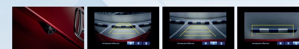
ກ້ອງຫຼັງບັນທຶກເບິ່ງເຫັນໄດ້ 3 ລະດັບ Multi-Angle Rearview Camera ຊ່ວຍເພີ່ມການເບິ່ງເຫັນໃນເວລາຖອຍຫຼັງ ໂດຍສາມາດເລືອກເບິ່ງກ້ອງທີ່ແຕກຕ່າງທັງ 130 ອົງສາ, 180 ອົງສາ ແລະ ຈາກທາງເທິງ
